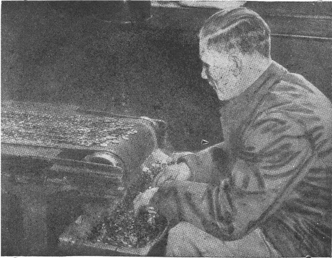
شكل (٩٧) فحص القطع ذات الثلاث بنسات الحديثة الصنع
