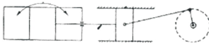
محرك ذو مكبس مزدوج الفعل (متصل برأس صليبي)
