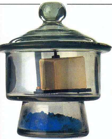
يستخدم جل السليكا في وعاء التجفيف لإزالة الرطوبة
