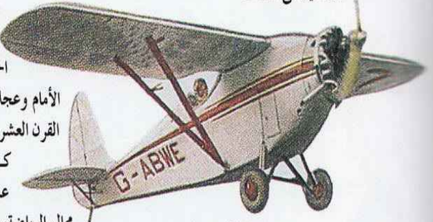
هيكل الطائرة مصنوع من الألومنيوم
