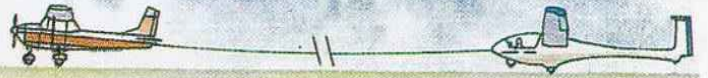
طائرة السحب ذات المحرك تقطر الطائرة الشراعية بحبل يصل طوله إلى 40 م (أى ما يعادل 120 قدماً)
