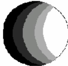
شكل (٤.٣) توزيع التيار في الموصل نتيجة للتأثير السطحي والتأثير التجاوري
